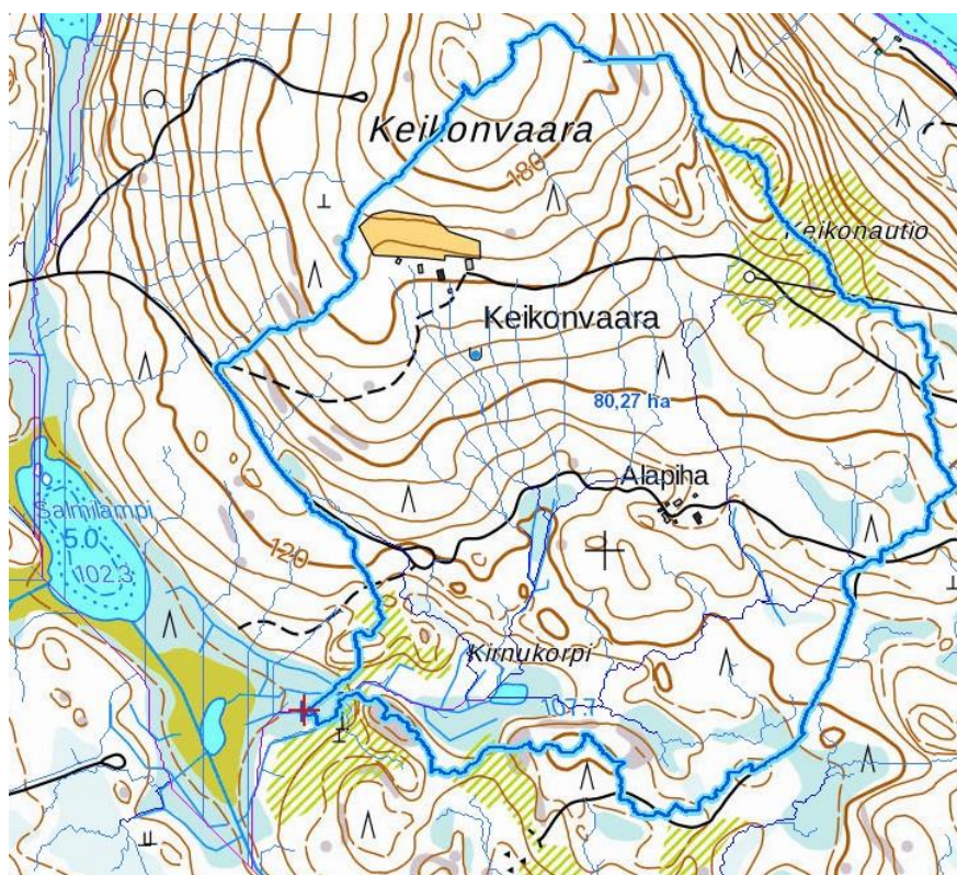
Kuva 5. Leton sijainti suhteessa yläpuoliseen vaaraan ja sen veden liikkeisiin. Kirnukorven kautta purkautuvat vedet johtuvat oja pitkin joko luhdan keskelle tai lähtevään uomaan. Sinisen viivan rajaama alue kuvaa valuma-alueen ja punainen risti kuvaa Metsäkeskuksen karttapalvelun input-arvona syötettyä purkupistettä. Ohuet sinertävät viivat kuvaavat virtausverkkoa. Veden virtaama kasvaa järjestyksessä: vaaleansininen, tummansininen, violetti. Lähteet: Suomen metsäkeskus, Maanmittauslaitos.
